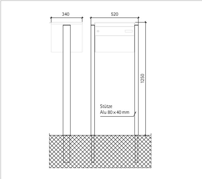
Untere Stütze zum Einbetonieren
