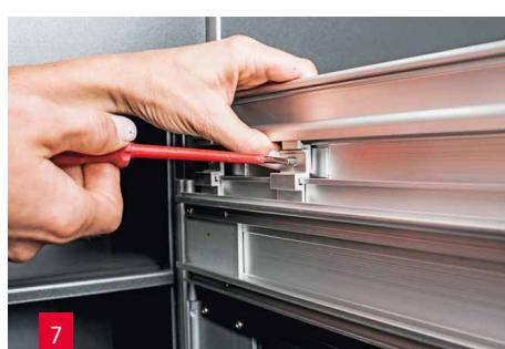
Namensschild und Arretierung durch Anziehen der Schraube befestigen. Schraube nicht zu stark anziehen, ansonsten wird die Front verbogen.
