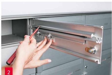
Befestigung des Namensschildes lösen.
