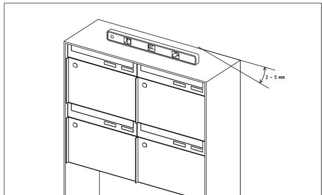
Bei Briefkastenanlagen mit Dach ohne Neigung kann das Wasser nicht abfliessen (kein Reklamationsanspruch). Je nach Grösse der Anlage können diese deshalb optional 2 bis 5 mm zur Seite geneigt montiert werden. Legen Sie die Neigung nie nach hinten: Dadurch schliessen die Briefklappen ungenügend. Wasser kann eindringen und die Post wird nass.
