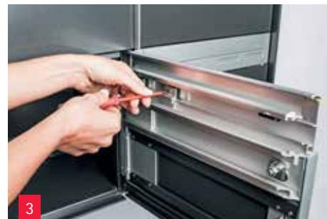
Befestigung Namensschild lösen.
